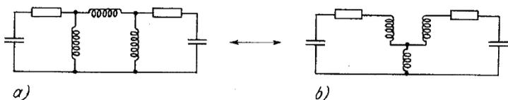
Bild 6. Induktive Kopplung; a = Dreieck, b = Stern
