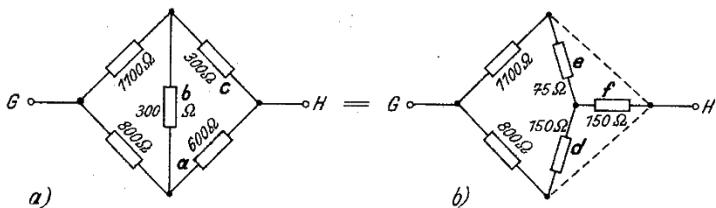
Bild 5. Berechnung des Ersatzwiderstandes einer Brückenschaltung
