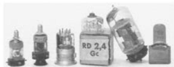
Bild 570 [Sammlung Erb, Luzern] Kleinere Wehrmachtsröhren: RV2,4H300, RV12P2000, LG7, RD2,4Gc, RL4,8P15 und D1F
