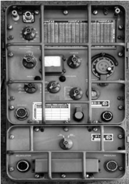
Bild 3: Das Nachfolgegerät RUP-4 der ehemals jugoslawischen Armee, unten das Stromversorgungsteil PT-5.
