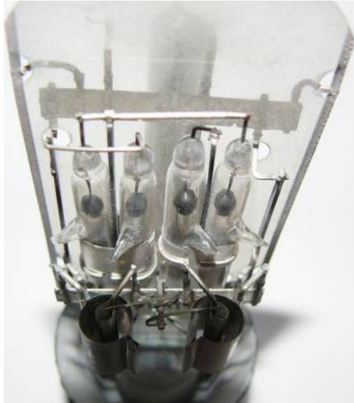
Anordnung der Widerstände und Kondensatoren in der 3NFB
