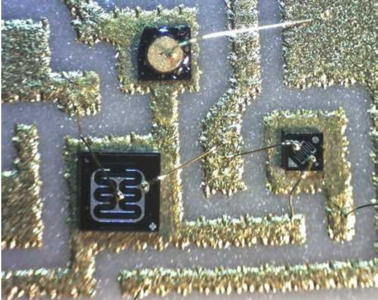
Bild 4: Detailbild von den Halbleiterbauelementen, Vergrößerung 60 fach
