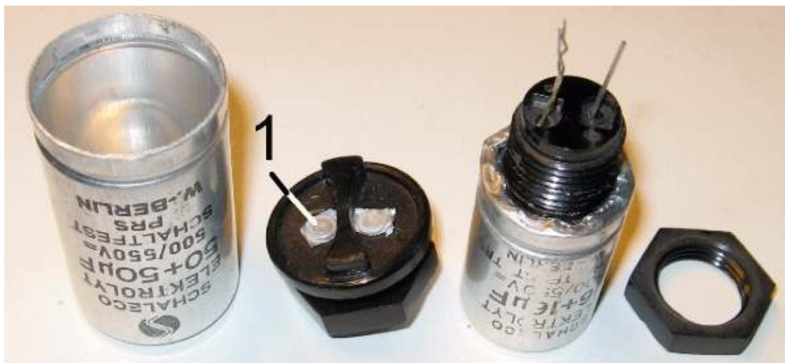
Bild 12 – Verschiedene Montagestadien, links gereinigter Becher mit Schraubstutzen, rechts ein "zurückgebördeltes", einbaufertiges Exemplar
