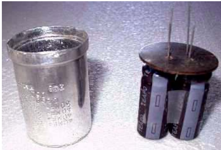
Bild 9 – Fertig bearbeiteter und gereinigter Becher mit Ersatz-"Innereien"
