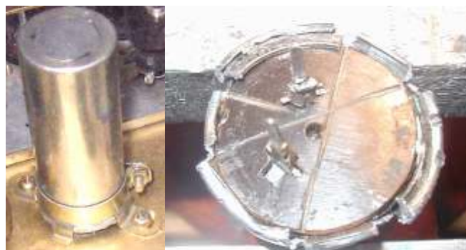
Bild 6 – Links: Elko mit Klemmschellenbefestigung; rechts: eingesägter und teilweise aufgebogener Becherrand
