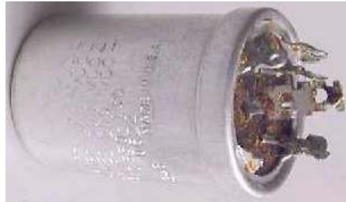
Bild 3 – Der ausgebaute Original-Elko
