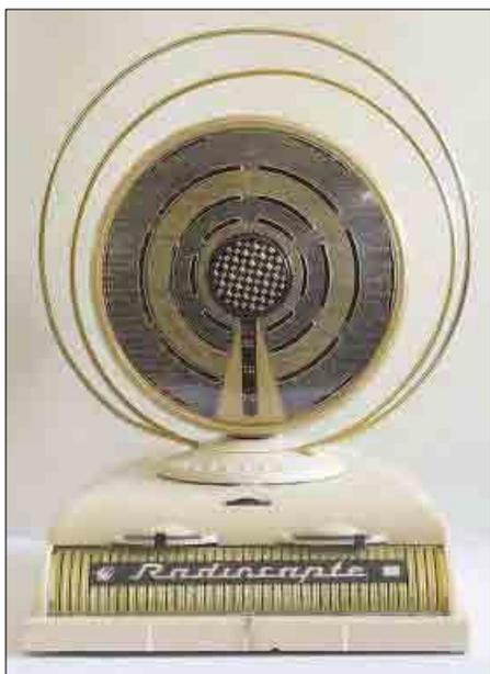
Der Radiocapote ist ein Superhet zum Empfang der Kurz-, Mittel- und Langwelle und wurde Mitte der 50er Jahre in Frankreich gebaut.
