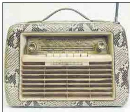
Dieser edle Koffersuper, der Loewe Opta Lord für UKW, KW, MW und LW, mit Schlangenlederbezug aus dem Jahr 1956 war noch mit Röhren bestückt. Die zum Betrieb notwendigen Anodenbatterien hielten nicht lange. Das Gerät kostete damals 259 Mark.
