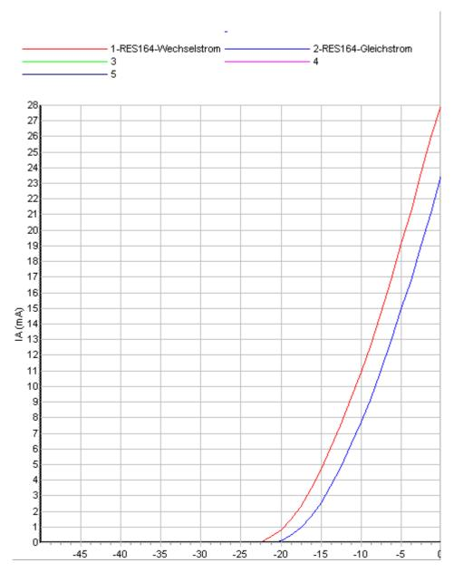
Ergebnis: Bei Gleichstromheizung (blaue Kennlinie) ist der Anodenstrom gegenüber der Wechselstromheizung etwas niedriger. Die Kennlinie ist gleichmäßig nach rechts verschoben.
