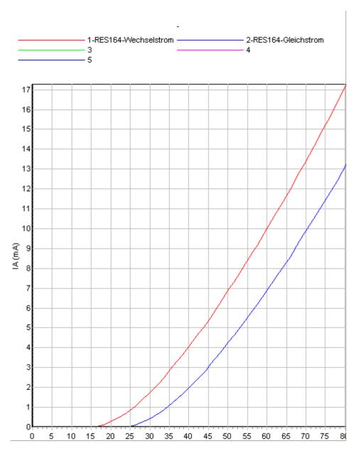
Ergebnis: Wie bereits bei der G1-Kennlinie ist bei der G2-Kennlinie der Anodenstrom bei Gleichspannungsheizung niedriger als bei Wechelstromheizung. Die Kennlinie ist wieder nach rechts verschoben.
