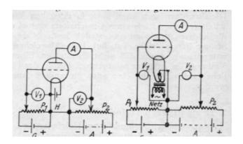
Bei <u>Wechselstromheizung</u> liegt über die gesamte Fadenlänge das gleiche Potential (gleichspannungsmäßig) an. Die Spannung schwankt um <u>O Volt</u> (vom Maximum über Null zum Minimum).
