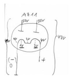
Beim linken System weist der Heizfaden im Schnitt ein um 1V höheres Potental ggü. Masse auf. Beim rechten System in o.g. Beispiel ein um 3 V höheres Potential.
