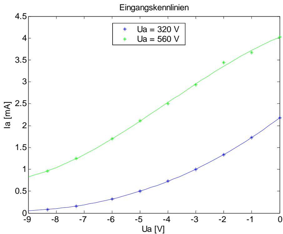
Steuerkennlinien für  $U_a = 320$  V und 578 V.
