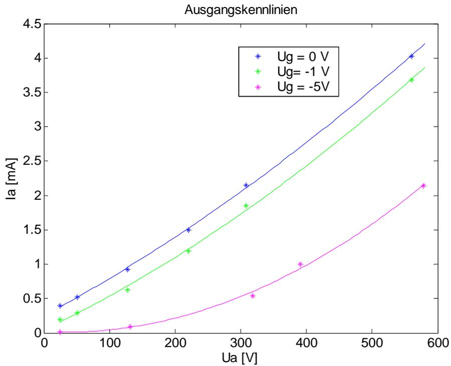
Ausgangskennlinien für  $U_g = 0$ V, -1V und -5V
