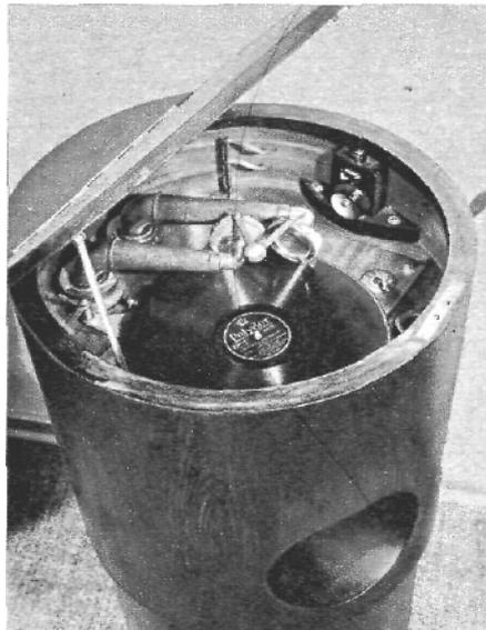
Bild 2. Blick in das Oberteil: Beide Tonarme sind miteinander verbunden, beide Nadeln laufen in der gleichen Rille hintereinander im Abstand von 84 mm
