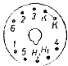
Verteilung der Röhrenkontakte am Zehntiftstahlröhrensockel beim RPG 4/3 von Funke, Weida. Sockel von unten gesehen
