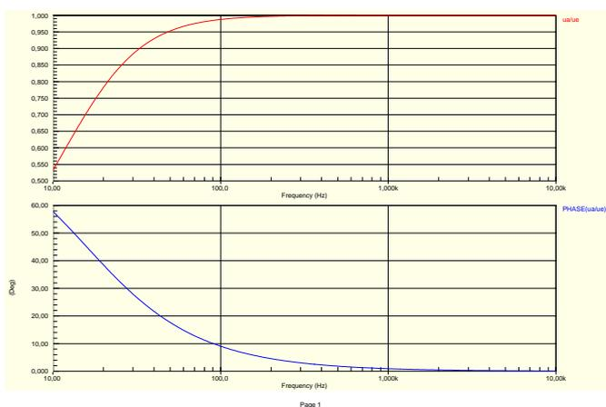
Plot mit einem CR Glied von 10nF/1M. Das würde dann schon zu einem deutlichen Fehler bei der Kanaltrennung führen.
