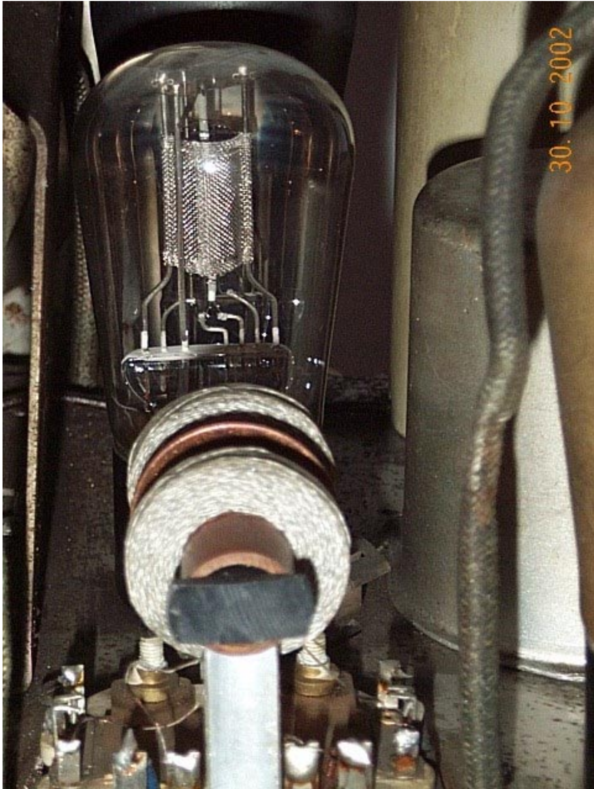
Bild 9 – Blick auf das 2. ZF-Bandfilter bei abgenommenem Abschirmbecher und die REN704d im Hintergrund. Der Abgleich des Bandfilters erfolgt rein kapazitiv per Verbiegung des Glimmerblättchens (mittels Schraube, die durch die Glimmerplättchen des Trimmers geführt ist). Das Bandfilter ist auf einem massiven Keramikträger montiert. Es werden ausschliesslich Luftspulen verwendet. Die schwarzen Endstücke am Papprohr halten den Abschirmbecher auf Distanz.
