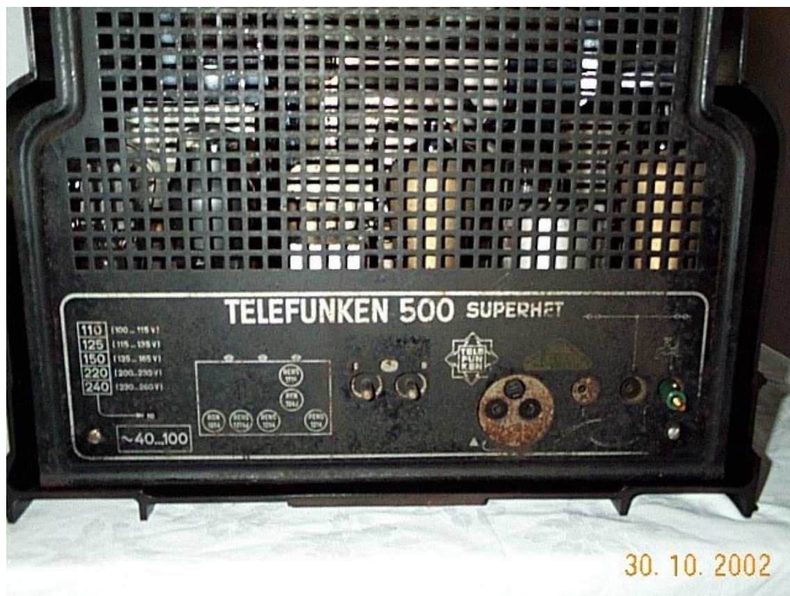
Bild 4 – Rückwand aus massivem Stahlblech. In der Mitte über den TA-Buchsen befindet sich der Regler für die Arbeitspunkteinstellung des Anodengleichrichters (Drahtpoti 10k). Dessen Regelbereich reicht häufig nicht aus, um bei üblichen Streuungen der Endröhre RENS1374d nach deren Wechsel einen geeigneten Arbeitspunkt für die HF-Regelung zu finden (Streuung des Anodenstromes und damit Beeinflussung der HF-Röhren über das Netzteil). Hier hilft nur Ausprobieren verschiedener "gut" getesteter Endröhren.
