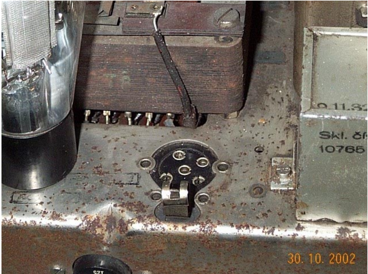
Bild 12 – Detailansicht der Fassung der RENS1374d. Gut zu erkennen die Konstruktion des Schirmgitteranschlusses und die tschechische Bedruckung des Blockkondensators. Die Jahreszahl sagt 9.11.32.
