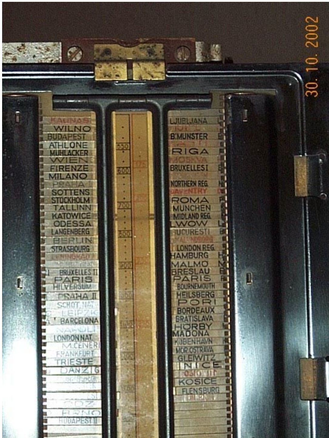
Bild 3 – Detailansicht der Skala. Die Stationsnamen sind auswechselbare Plastikschildchen, bemerkenswert die internationalen Städtenamen (Praha, Roma, Bruxelles etc.). Ein Kuriosum ist der Langwellenbereich: Dieser überstreicht nur ca. 2/3 der Skala (rote Schrift bzw. rechte Hälfte des Frequenzdruckes).
