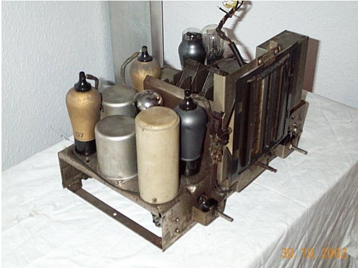
Bild 8 – Blick auf die HF- und ZF-Stufen. Der grosse Becher ganz vorn beinhaltet die Antennenkreise. Die graue RENS1214 ist die HF-Vorröhre. Hinter dieser steht die Mischröhre REN704d. Das erste ZF-Filter befindet sich hinter dem Antennenkreis. Am linken Chassisrand kann man die ZF-Röhre RENS1214 erkennen. Zwischen dieser und der im Hintergrund erkennbaren RENS1204 hockt das zweite ZF-Filter. Vorn ist neben der Skala der Schwenkmechanismus der Skalenlampe zu sehen. Mittels dieser aufwendigen Mechanik konnte die Skalenlampe einfach gewechselt werden.
