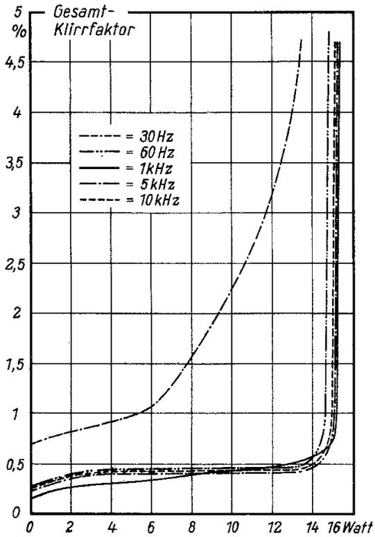
Bild 2. Klirrfaktorverlauf des Nf-Verstärkers
