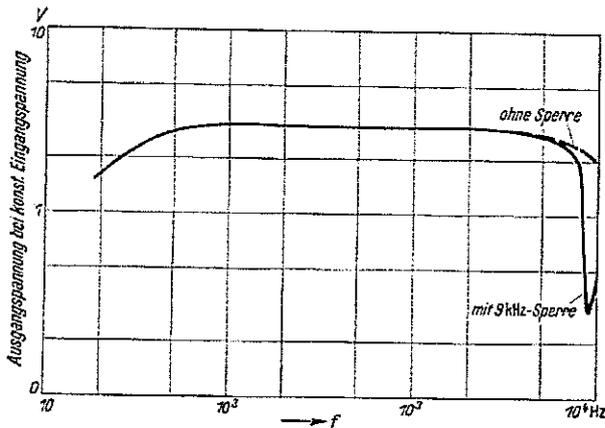
Bild 4. Übertragungskurve des NF-Teiles.
