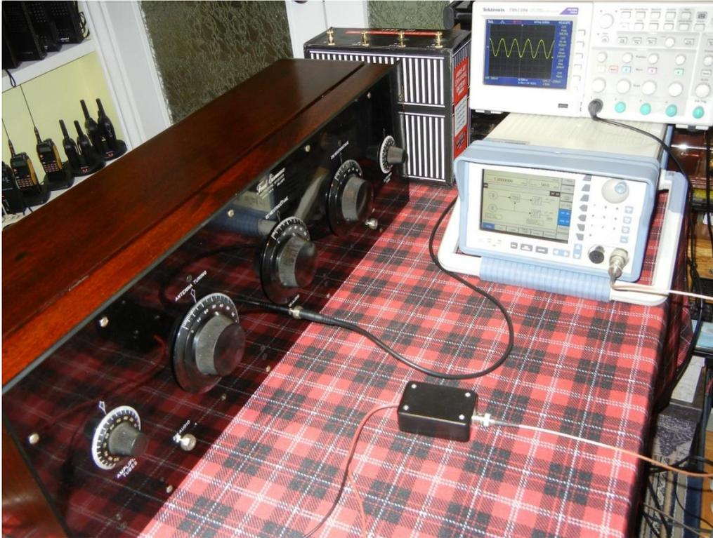
Fig. 4. Le banc d'essais de la radio : générateur de signal et oscilloscope
