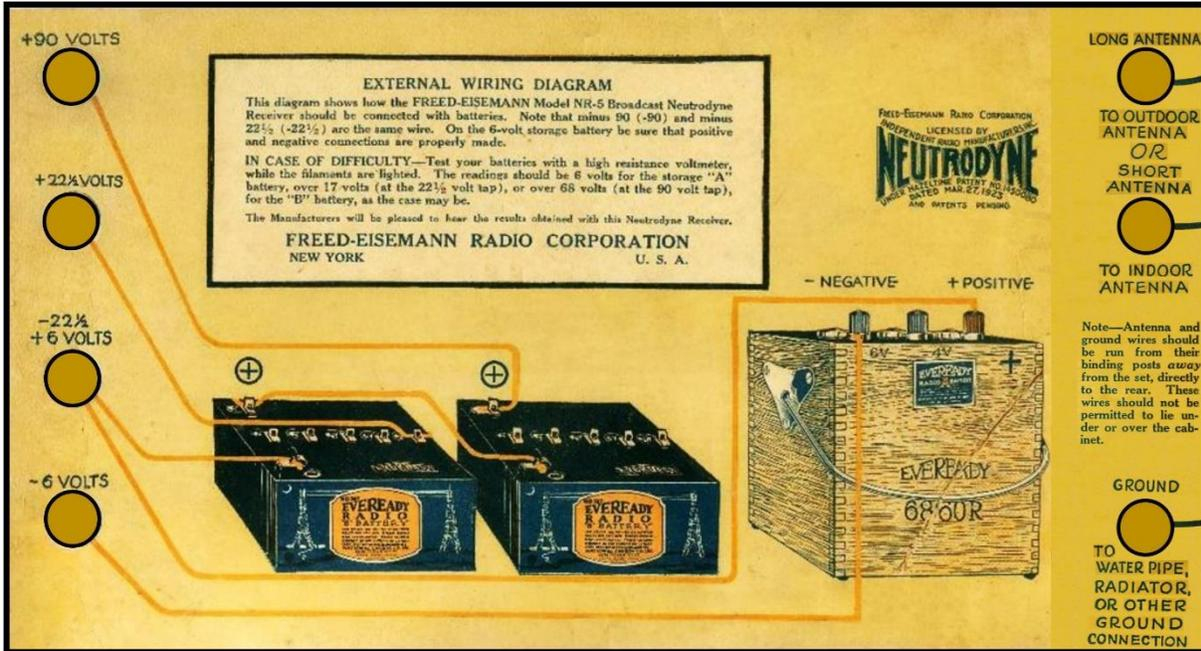
Fig. 3. Le diagramme de fils imprimé en arrière de la radio Freed Eisemann no. 5 (restauration)
