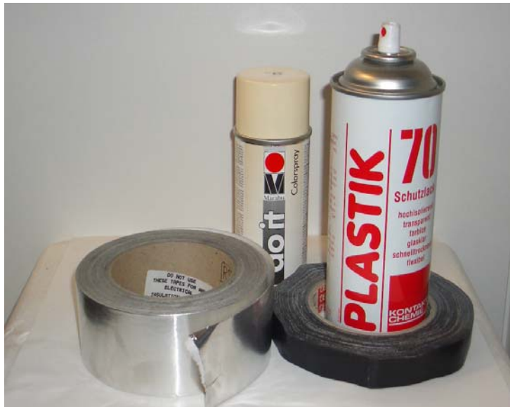
Abb7: links, der Typ der verwendeten Overheadfolie, rechts die Materialien: Plastik 70 Lack, „do it“ beige der Firma Marabu (aus dem Baumarkt), schwarzes Gewebband von Tesa und selbstklebende Aluminiumfolie (die gibt's bei Conrad Elektronik als Abschirmfolie).
