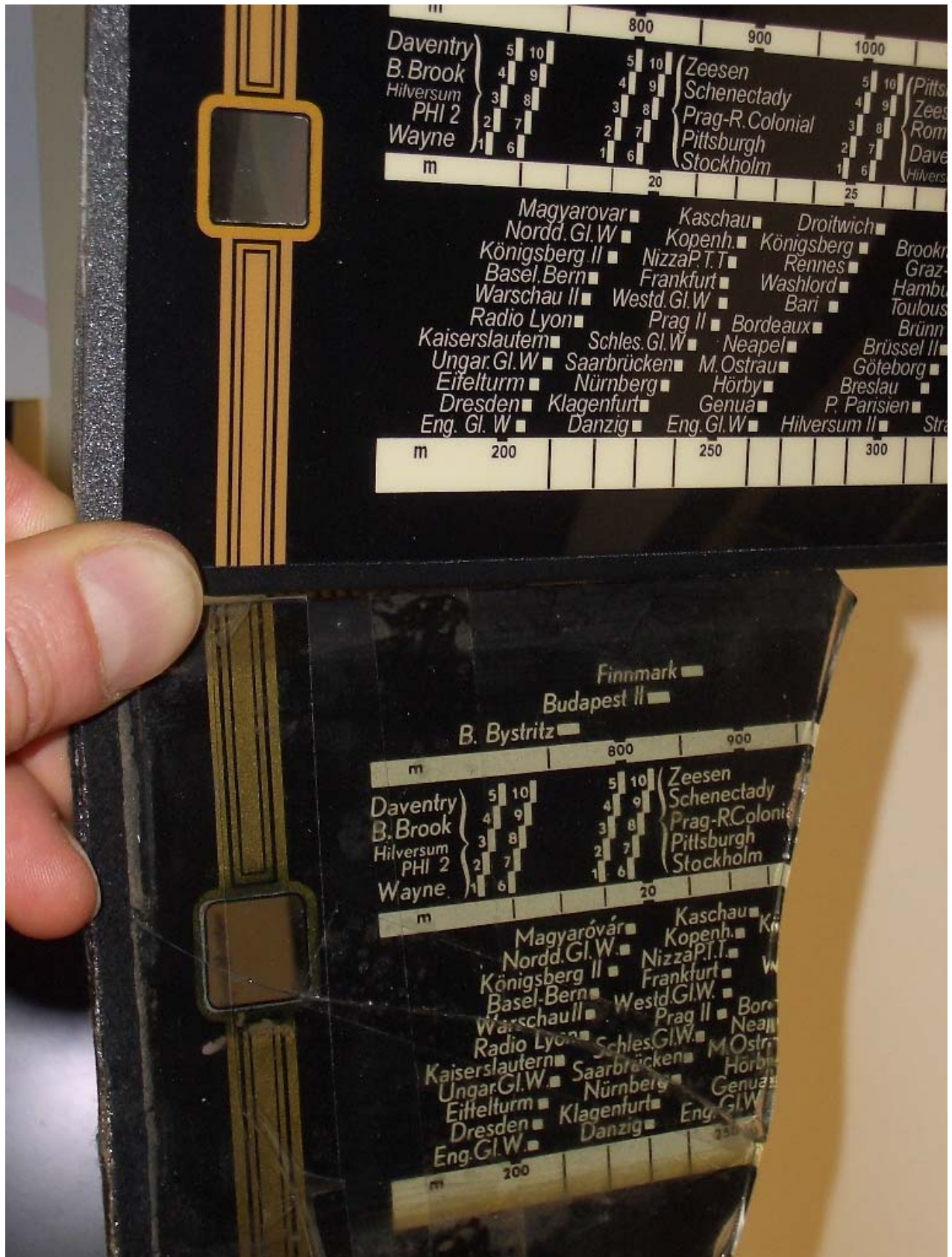
Abb6: Durchlichtvergleich zwischen dem Bruchstück des Originales mit der Nachgebauten Skala (oben). Die schwarzen Flächen sind jetzt lichtdicht, jedoch die goldenen Streifen leuchten im Unterschied zum Original etwas durch. Will man das auch noch verhindern kann man die Flächen hinten mit schwarzem Karton abdecken.
