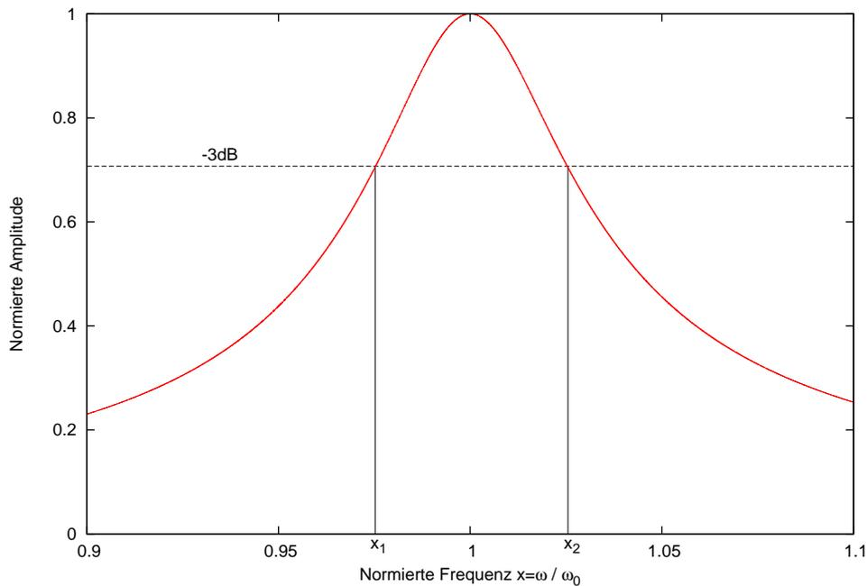
Abbildung 4: Grenzfrequenzen und Bandbreite
