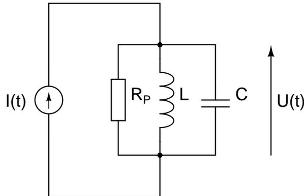
Abbildung 1: Parallelresonanzkreis, Antrieb durch eine Wechselstromquelle
