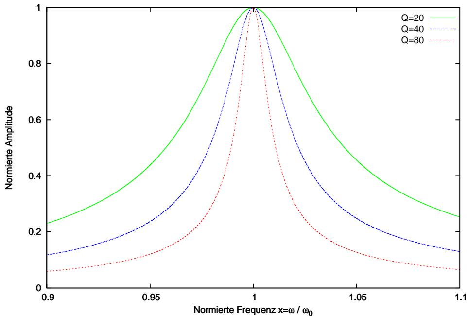
Abbildung 3: Verlauf der Resonanzkurve für verschiedene Gütefaktoren  $Q$
