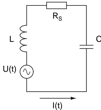
Abbildung 2: Serienresonanzkreis, Antrieb durch eine Wechselspannungsquelle
