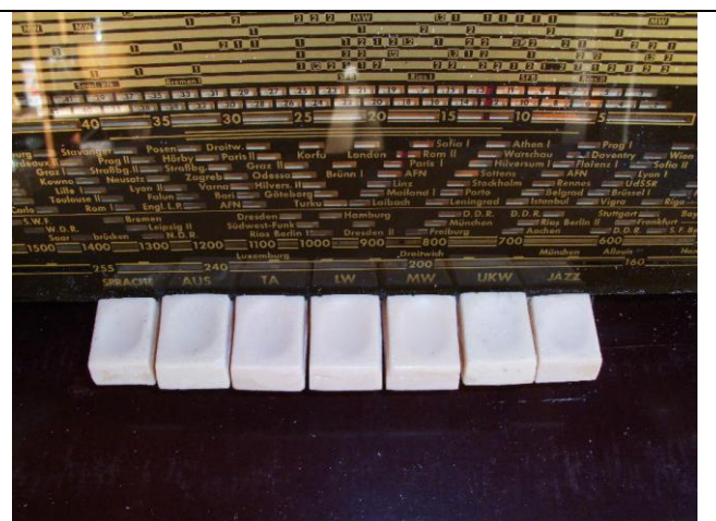
Bild 11 Tastensatz nach Einbau
