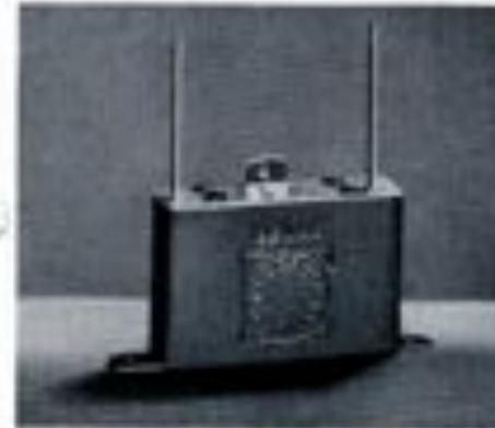
Die zulässige Höchstspannung beträgt 4000 Volt. Diese hohe Durchschlagsfestigkeit gestattet auch die Verwendung als Senderkondensatoren von kleinerer Leistung. Zur Kapazitätsvergrößerung von Drehkondensatoren durch Parallelschaltung geeignet.
