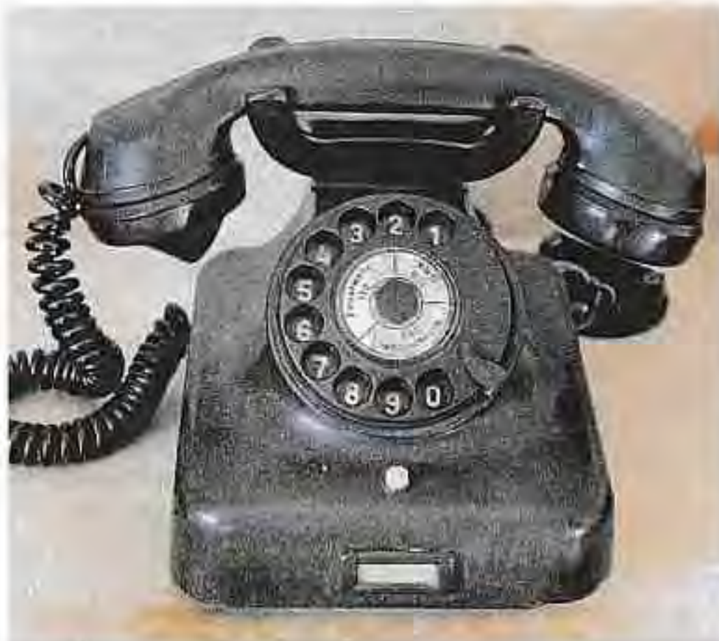
Der Tischfernsprecher W38 wurde 1938 maßgeblich von der Firma Siemens & Halske entwickelt und von Herstellern in Lizenz gebaut.
