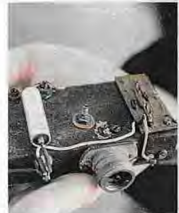
Ein Eigenbau-Tuner für das zweite Programm des Westfernsehens
