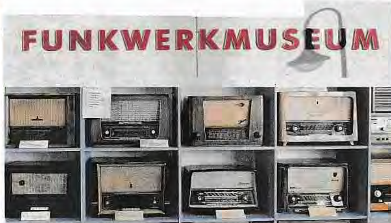
Für den guten Klang dieser Röhrenradios waren nicht zuletzt die wohlproportionierten, massiven Holzgehäuse verantwortlich.
