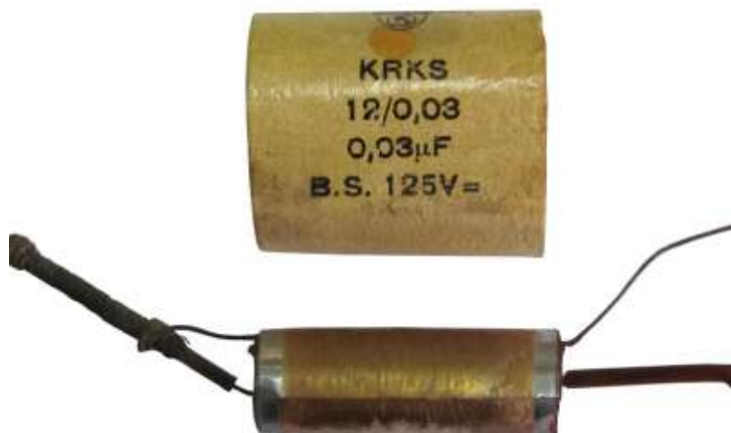
Der defekte Kondensator, geöffnet
