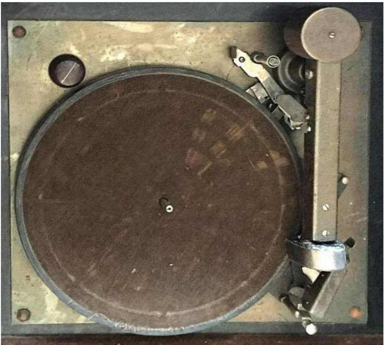
Blick auf das Laufwerk mit Lift und Endabschaltmechanik
