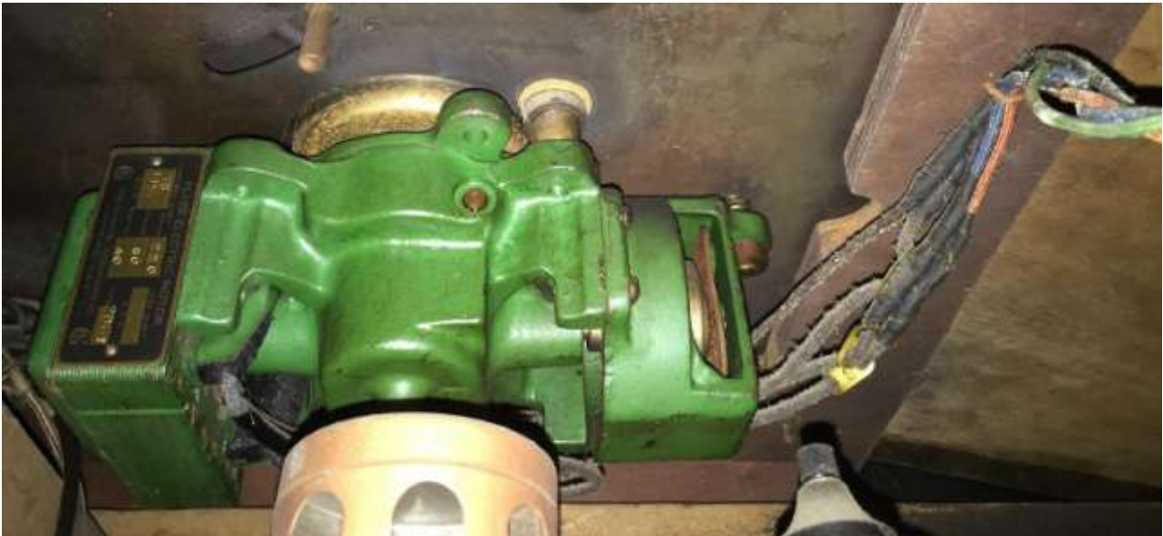
Der Antriebsmotor, Marke „FLYER-ELECTRIC“. Darunter ist ein Teil des Radiochassis sichtbar
