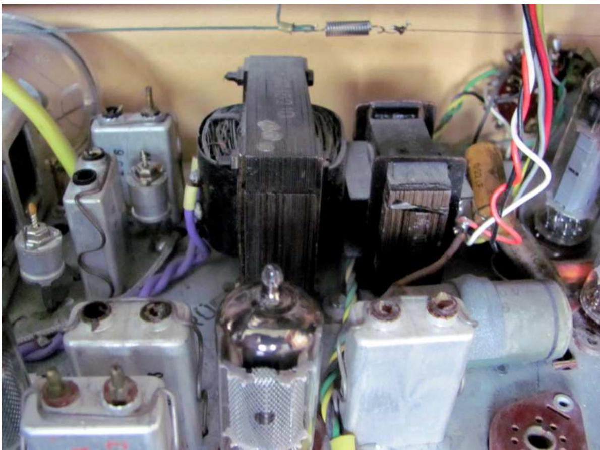
Detailansicht der Endstufe mit Ausgangstrafo und Drossel
