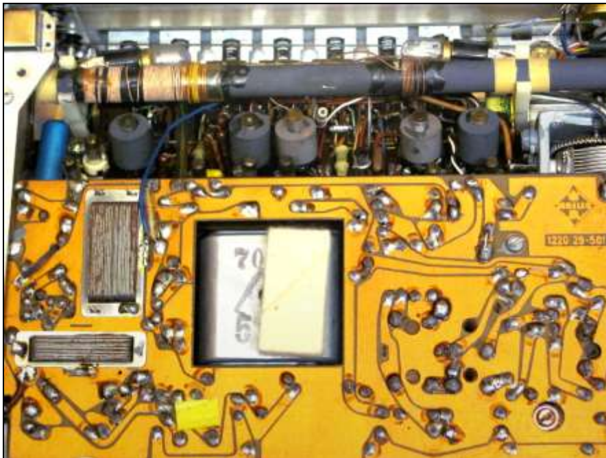
Blick auf die Lötseite der Printplatte und Abgleichplatte
