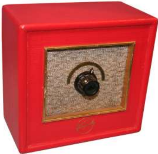
KAPSCH Mucki 1948 bestückt mit den Röhren UCH 4 und VY 2 (Kapsch Corporate Museum)
