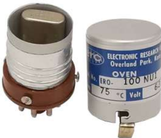
ERC Electronic Research "Ofenfrisch" Dual Quarzofen für 75°C aus dem Nordmende Elektronenschalter und Quarzmarken Einschub, 1969, (Sammlung W. Scheida)
