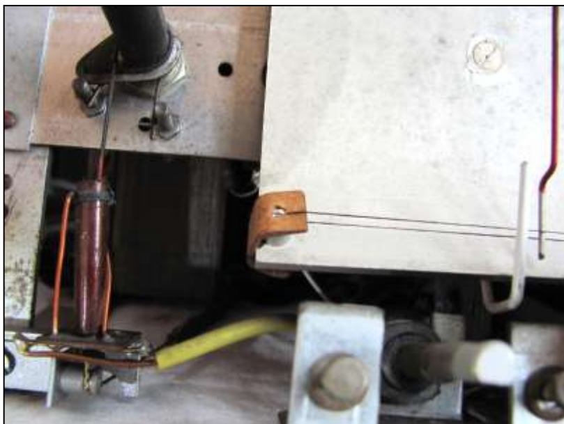
Detail UKW-Zeiger und KW-Feinabstimmung
