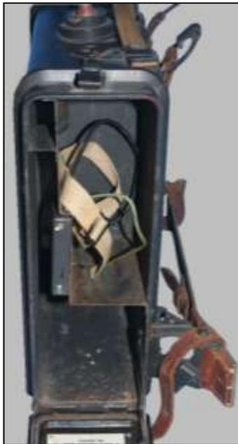
der Nickel-Cadmium-Sammler 2,4NC28 und im übrigen Raum Antenne, Kopfhörer, Kehlkopfmikrofon f, Fernbedienungskabel b und die Rückenstütze a untergebracht. Nach der Festlegung, zwei Kopfhörer beizustellen(.), musste deshalb die Rückenstütze a entfallen(-).
