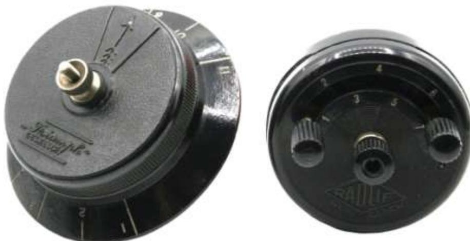
**Die schaltbaren von Triumph (Skalenlichtantenne)(li.) und Radlif (re.)**
