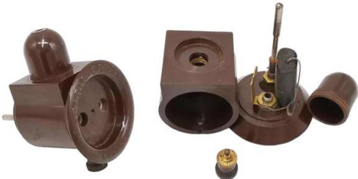
***"Garantierter Empfang?" Radio-Garant; Made in Austria. Im Bild rechts ist ein Kondensator mit Teerverguss zu erkennen, dessen Isolation absolut keine Sicherheit mehr bietet – mit Garantie ist dieser defekt und lässt die Netzspannung durch!***
