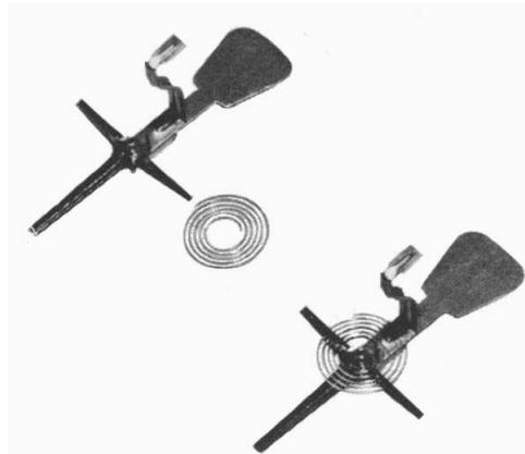
Bild 18. Zeigerkreuz mit und ohne Spiralfeder.
