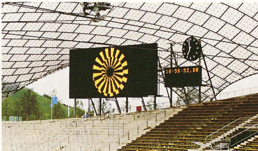
Anzeigetafel im Olympiastadion. Sie wird direkt vom Computer angesteuert. Die Schrift entsteht nach dem Matrixverfahren. Die Gesamtabmessungen der Anzeigetafel sind 18,4 m x 11,6 m
