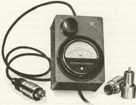
UKW-Tast- und Durchgangsvoltmeter UDND für 0,1 bis 50 V und 500 MHz als Tastvoltmeter sowie bis 1000 V und 2000 MHz mit Durchgangsköpfen (1941).
