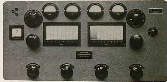
Allwellen-Frequenzmesser WIP für 50 kHz bis 50 MHz, die erste Entwicklung nach Firmengründung, und Resonanzfrequenzmesser WAR für Dezimeterwellen von 1935 (unten).
