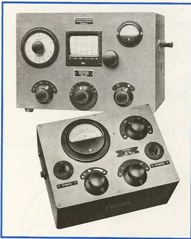
Um 1938 entstanden der Leistungs-Meßsender SML (200 mV bis 10 V an 150 \Omega ) und der Ohmsche Eichleiter DUR, der es ermöglichte, aus dem SML kleinste Spannungen abzuleiten.
