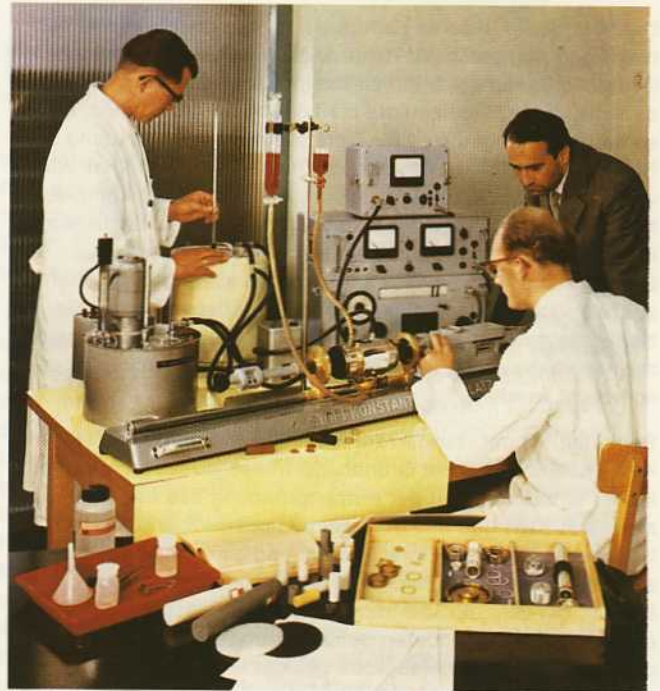
Stoffkonstanten-Meßplatz (1958) für die Untersuchung der Materialeigenschaften von festen und flüssigen Stoffen bei Frequenzen bis 7 GHz.
