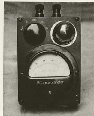
Kompensations-Röhrenvoltmeter UDC für 0,5 bis 500 V (1933) und Taschen-Röhrenvoltmeter UDT für 0 bis 250 V, mit Spannungsteiler-Vorsatz bis 2500 V (1936).
