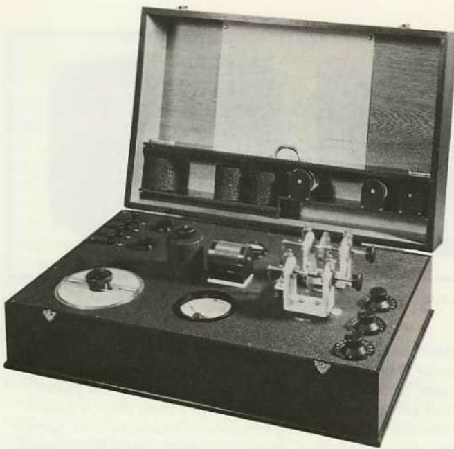
Verlustfaktor-Meßgerät für 0,1 bis 10 MHz, 1934 entwickelt von Rohde & Schwarz, gefertigt für Siemens.
