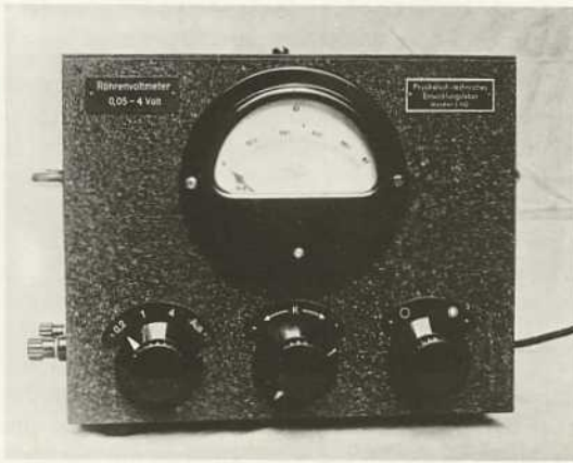
Röhrenvoltmeter UTK (Bild) und Taströhrenvoltmeter UTKT für 0,03 bis 3 V und 10 kHz bis 300 MHz entstanden 1936.
