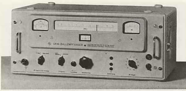
Hochwertiger UKW-Ballempfänger ESB (1951) für die drahtlose Programmübertragung zu einem Tochtersender.
