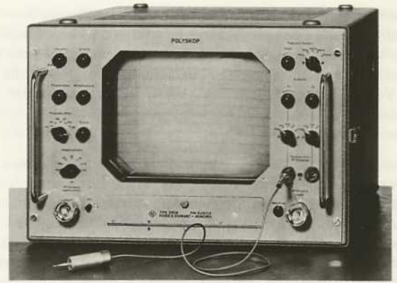
Wobbelmeßplatz Polyskop SWOB (0,5 bis 400 MHz) zur gleichzeitigen Darstellung der Frequenzabhängigkeit von Übertragungsmaß und Impedanz auf einem Bildschirm (1958).
