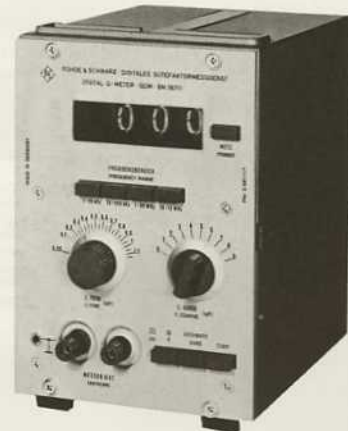
Digitales Gütfaktormeßgerät QDM (Q 10 bis 1000) mit automatischem Meßablauf (1970).
