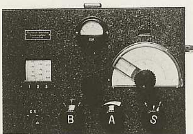
Kapazitätsmesser mit Toleranzeinstellung KSR zum Sortieren von Kondensatoren (1934).
