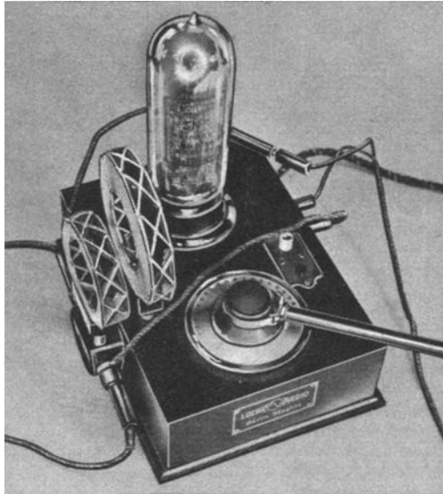
Wie die Verbindungen am Loewe-Gerät zu ziehen sind und auf welche Weise mit einer Erdungsschelle die Feineinstellung gemacht werden kann
