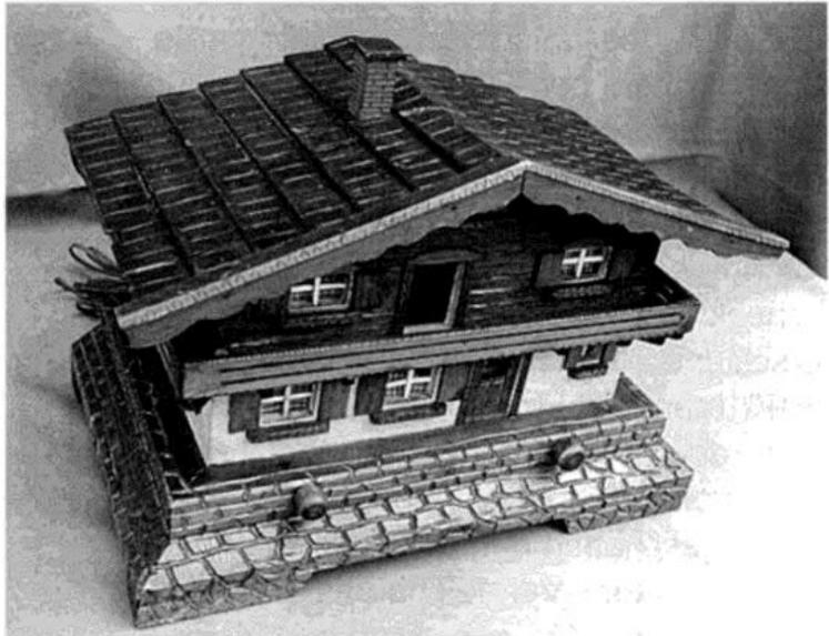
Bild 1: Schindelgedeckt, mit herrlichem Balkon und auf festem Grund gebaut, macht das „Alpenhaus-Radio“ einen gemütlichen Eindruck. Die Abstimmkala erscheint in der oberen Tür. Röhren: UF6, UL2, UY3
