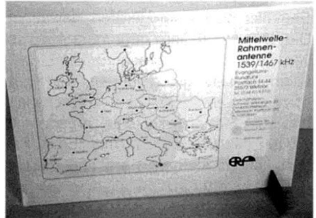
Bild 1: ERF-Rahmenantenne für 1539 kHz (Mainflingen) und 1467 kHz (Monte-Carlo). Maße ca. 22,5 x 30 cm
