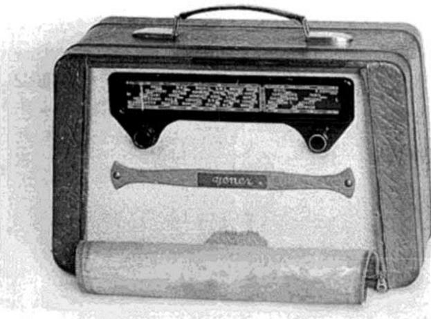
**Bild 8:** Koffer-Empfänger „Kamerad“ REB651. Baujahr 1951/52. Schaltung: 6-Kreis-Super für Netz und Batteriebetrieb (9V-Heizbatterie und 110V Anodenbatterie). Wellenbereiche: Lang, Mittel, 2xKurz. Röhren: DK91, DAF91, DF91, DL92. Besonderheiten: Eingebaute Rahmenantenne, Holzgehäuse mit echtem Leder bezogen. Preis: 310,60 DM
