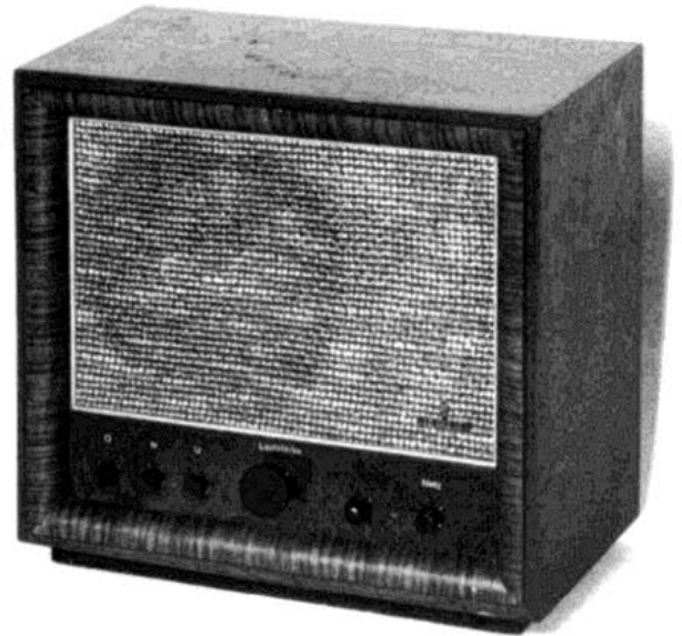
Bild 9: Drahtfunkempfänger Siemens Df 40 (1939/40). Links am Gerät die drei Tasten zur Programmwahl.
