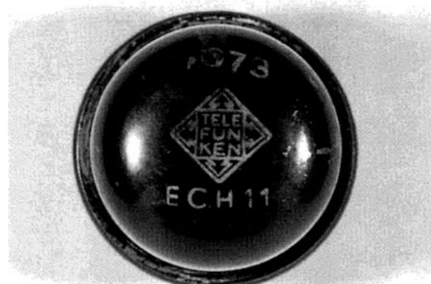
Bild 10: Es gab auch Philips-Röhren der kleinen Bauform mit Telefunken-Stempel!
