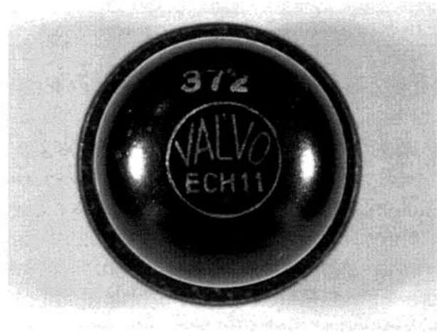
Bild 9: Charakteristischer Valvo-Stempel bei den Philips-Röhren der kleinen Bauform.
