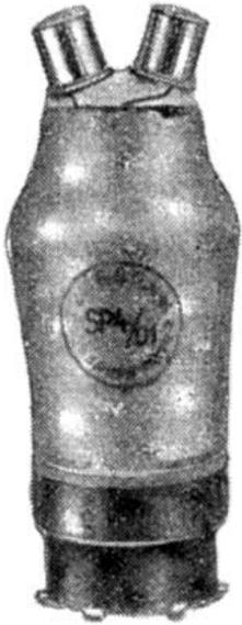
**Bild 6.3.7.2:** UKW-Pentode Tuningram (UK), Type SP4 / UI mit 2 Domkappen für Steuergitter und Katode (Gitterkreis) einem Katodenanschluss für die Anodenkreisrückführung, sowie einen weiteren zur Erdung (1939).
