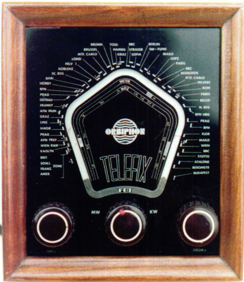
Bild 1: Supervorsatzgerät für Geradeausempfänger vom Typ FB 1 von Orbiphon.
