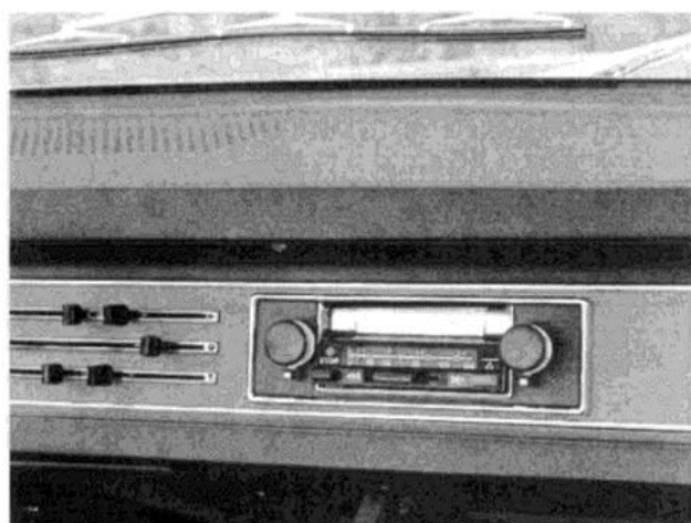
Bild 9: Blaupunkt mit Kassetten: Der Lübeck von 1970 gehört zu den Kassettenradios der ersten Generation (oben). Der Marburg (1971), ein Gerät für UKW, MW, LW, Kassetten-Aufnahme und Stereo-Wiedergabe (unten).
