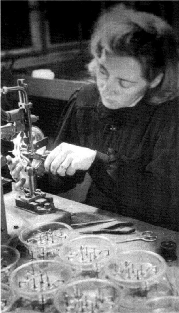
**Bild 6:** Punktschweißen der Röhrenfüße der AS 1010.
