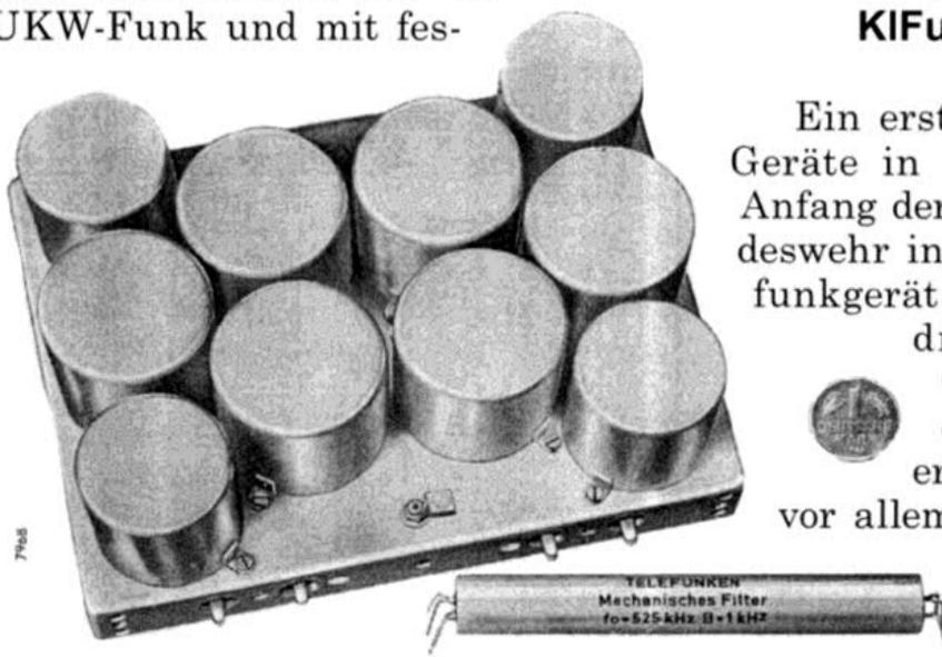
**Bild 3:** Größenvergleich zum ZF-Quarz-Bandfiltersatz im Empfänger E 127KW/5.
