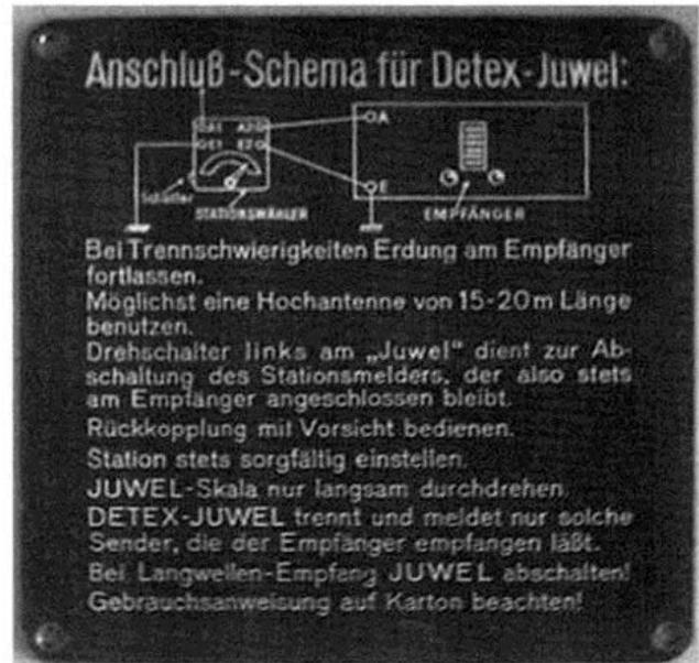
**Bild 2: Bodenplatte mit Anschluß-Schema**
