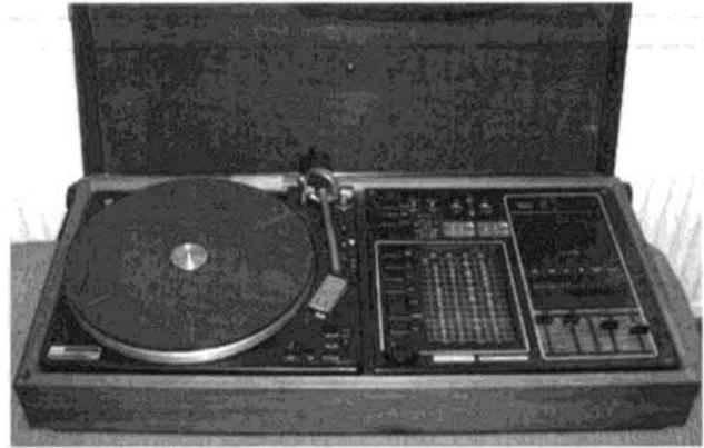
**Bild 6:** Das „3-in-1“-Gerät California. TA, Kassettentonband und Radio in einem Gehäuse.
