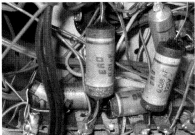
Bild 3: Die alten Folienkondensatoren haben oft den mehrfachen Wert ihrer Sollkapazität erreicht und sollten durch axiale Bauformen ersetzt werden.
