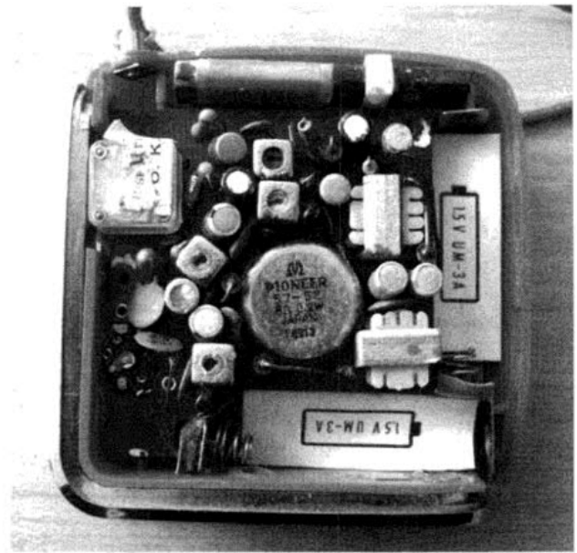
Bild 10: Der Grand Prix hat in der NF-Endstufe zwei Trafos.
