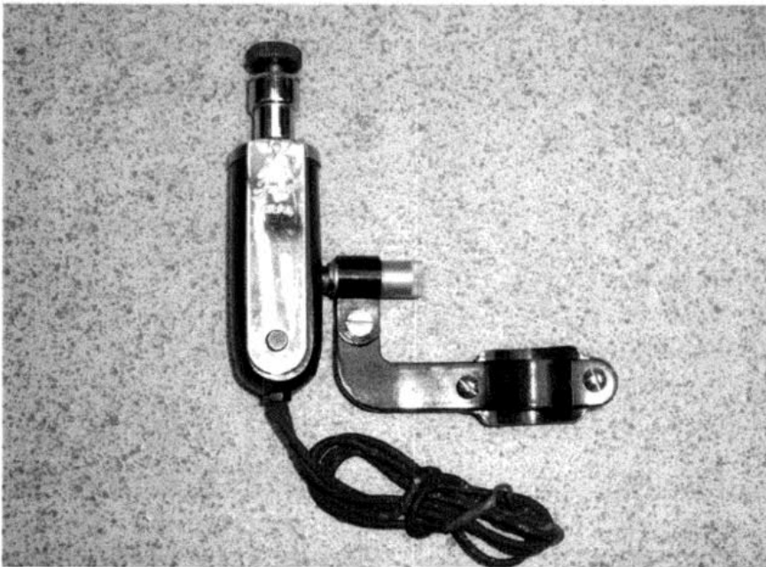
Bild 2: Der Friho-Fahrraddynamo. Er wird am Rahmen befestigt und vom Rad angetrieben.
