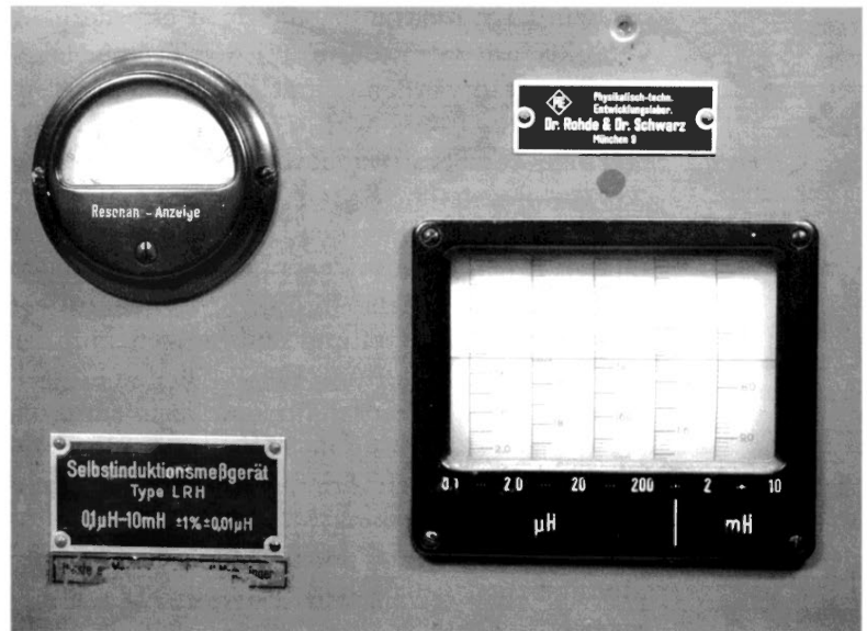
Bild 4: Resonanzanzeige und Trommelskala.
