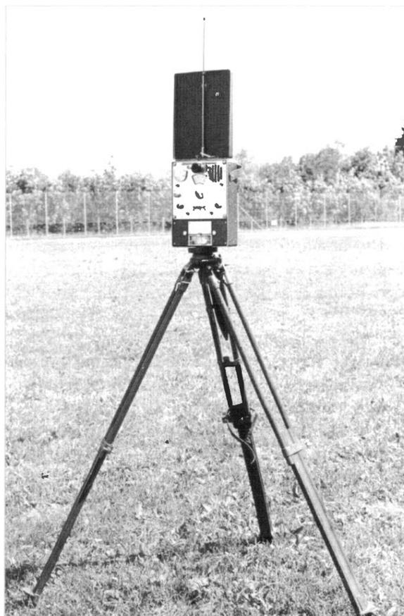
**Bild 8:** Vermessungspeiler TVP 405 der Firma C. Plath mit aufgeklapptem Deckelrahmen sowie stabförmiger Hilfsantenne.
