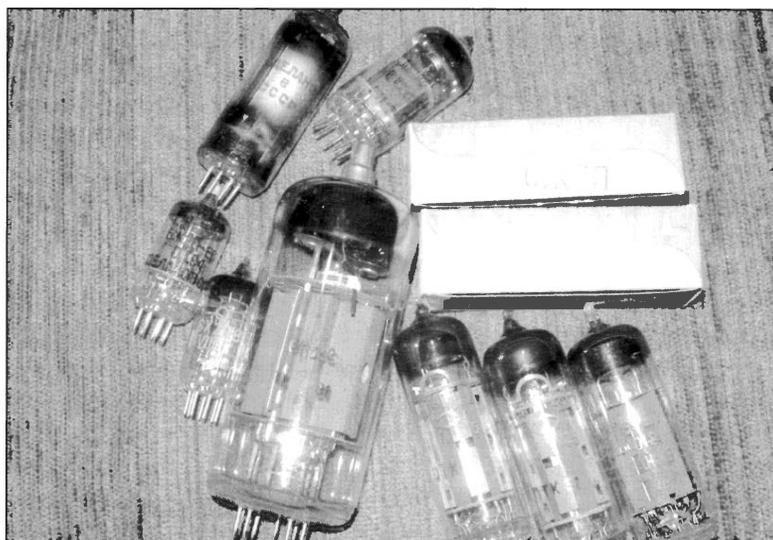
**Bild 1:** Russische Röhren, die Bezeichnungen sind (außer auf den Schachteln) schwer lesbar. Es handelt sich um 6Ж11П, 6Ж3П (oben), 6Ж2П (2x), 6П36С, 6П14П (2x) und 6Ф5П.
