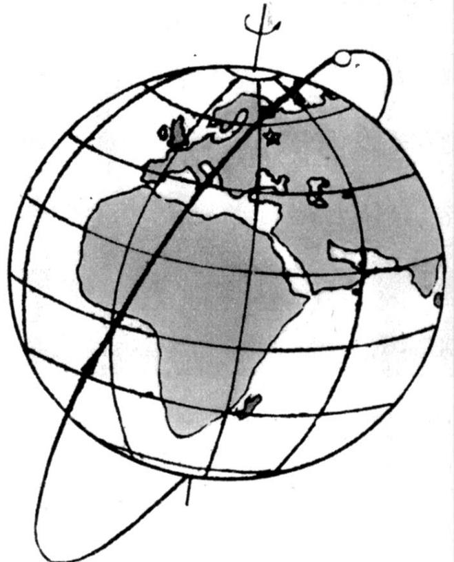
*Abb. 60. Die Bahn des „Sputniks 1“ um die Erde. Sie verlief anfangs in einer durchschnittlichen Höhe von 900 km und wurde mit einer Geschwindigkeit von 8 km/sec in 96 Minuten durchflogen.*
