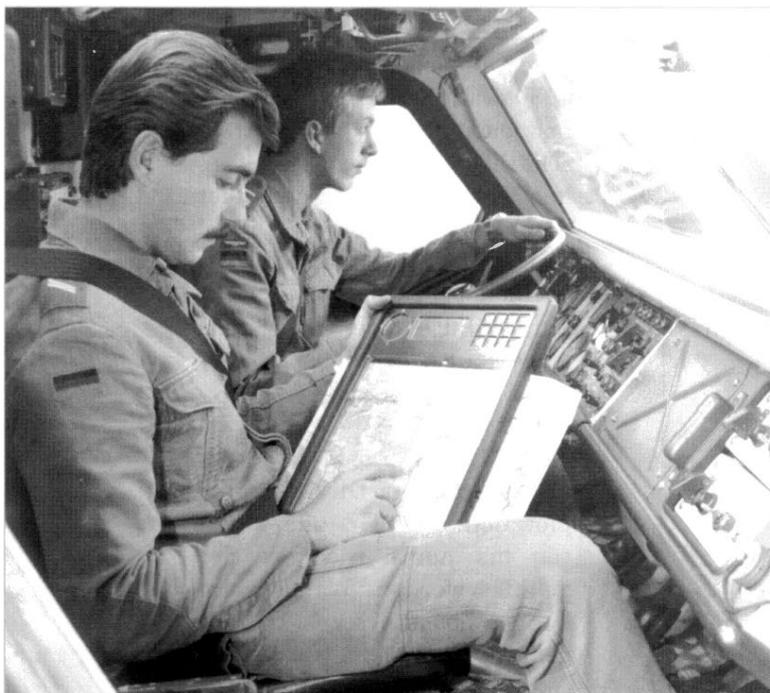
**Bild 10:** *Bedienfeld der Fahrzeugorientierungsanlage FOA-4, eingebaut im Armaturenbrett eines „Unimog“ mit dazugehörigem Kartenanzeigergerät.*
