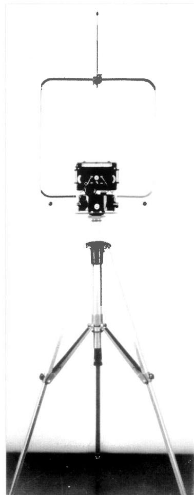
**Bild 6:** Peilgerät PE 484/2 mit drehbarem Teilkreis/Magnetbussole auf Fotostativ.
