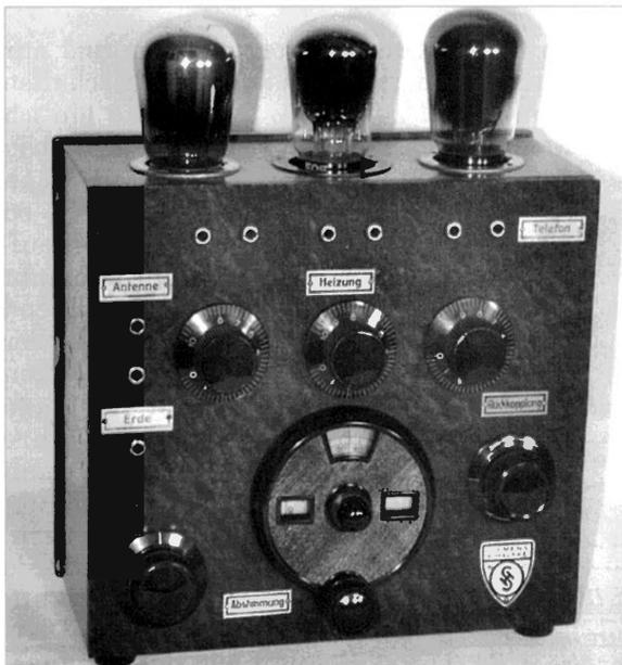
**Bild 3:** Ansicht des Dreiröhren-Empfängers von etwa 1928 in einem braun gebeizten und polierten Holzkasten-Gehäuse mit dem RTV-Stempel vom 12. Dezember 1923, der durch Umbau aus dem SIEMENS-Audionempfänger Rfe 1 entstanden ist.
