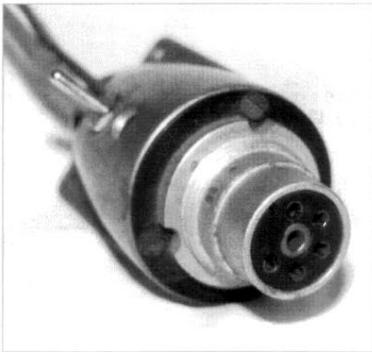
**Bild 8:** Das Zwischenstück, Typ 6 S Ela 1311, zum Aufstecken des Kondensatormikrophons bei Verwendung als Handmikrofon, auf Stativ oder zum Aufhängen. Es ist mit einem fünfpoligen Buchsenteil bestückt. Beim Umbau erhielt es einen Kippschalter zum Ein- und Ausschalten der 9-Volt-Batterie.
