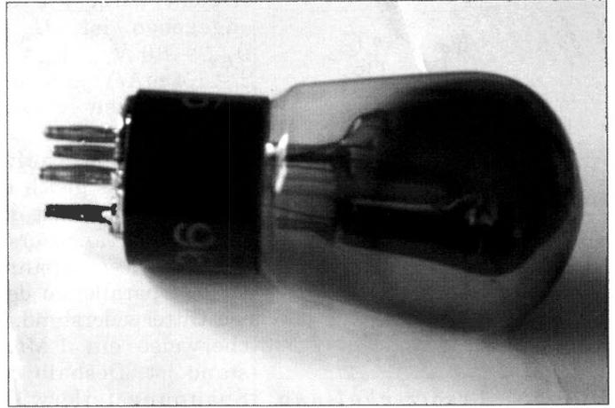
**Bild 6:** Die Röhre RES164 mit der Ersatzschaltung nach Bild 7a zwischen den Stiften.
