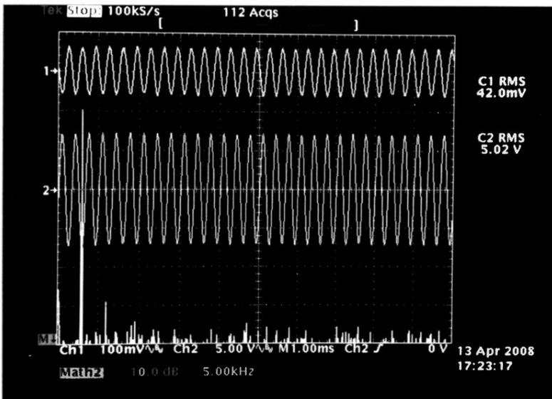
**Bild 4:** Oszillogramme vom Widerstandsverstärker. Kanal 1: Eingangsspannung  $u_G$ , Kanal 2: Ausgangsspannung  $u_A$ , Kanal 4: Spektrum der Ausgangsspannung,  $R_A = 68 \text{ k}\Omega$ , Verstärkung: 120-fach.
