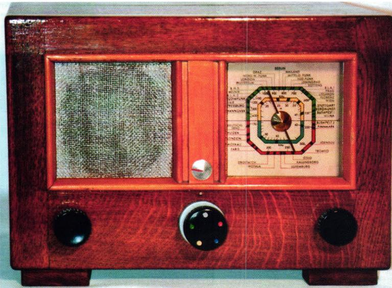
**Empfang:** KW 1 (gelb) 16 – 42 m, KW 2 (blau) 40 – 554 m MW (grün) 540 – 1450 kHz, LW (rot) 150 – 360 kHz
