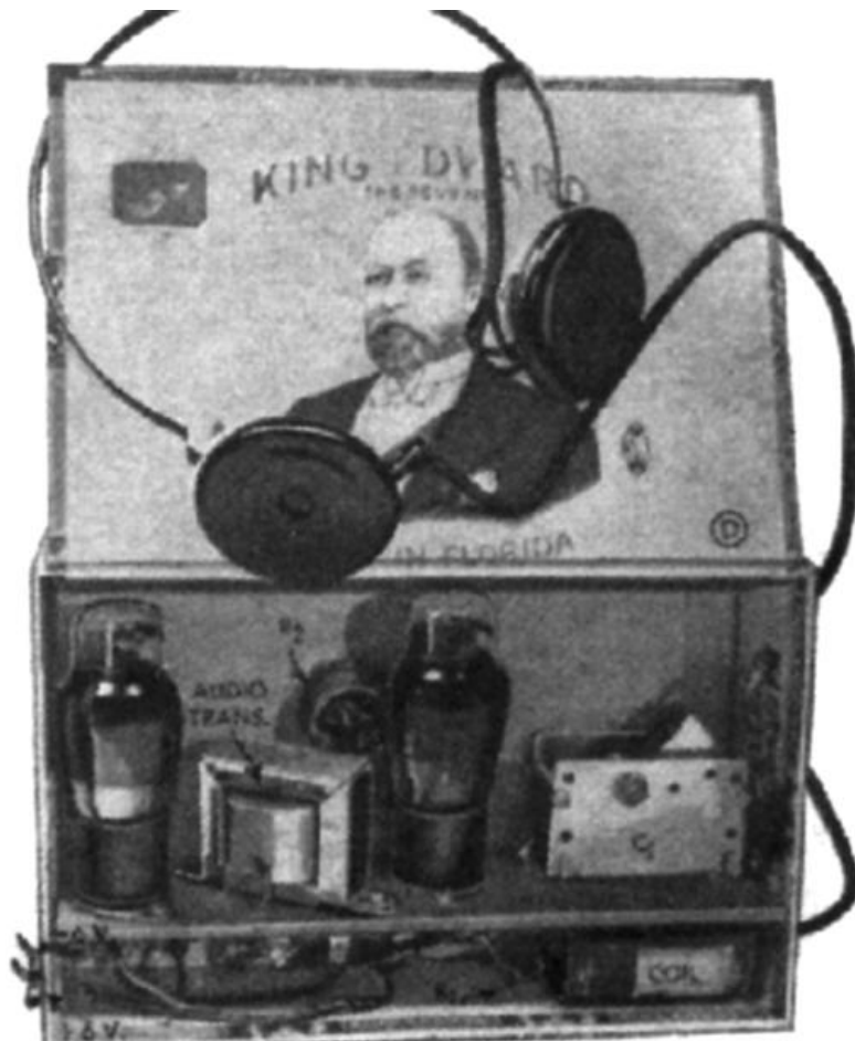
Bild 4: Der „Blackout Emergency Set“ arbeitet mit zwei Röhren vom US-Typ 6G6G
