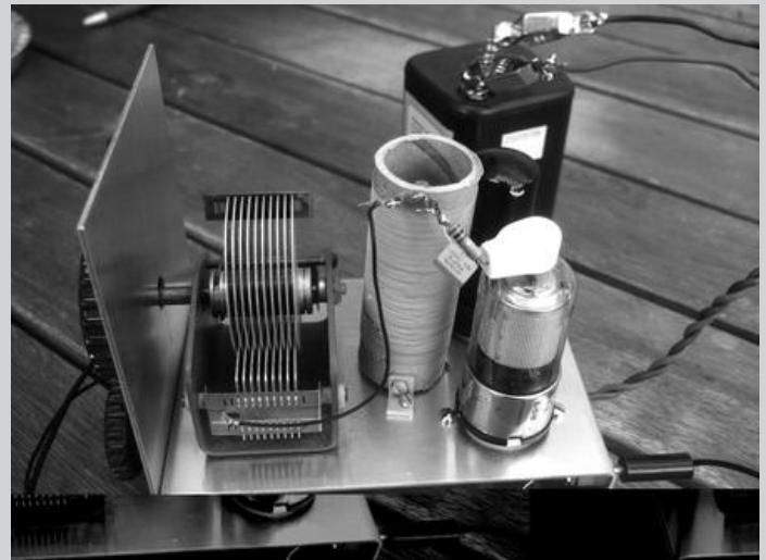
Bild 6: Betrieb mit einer 6-V-Lampenbatterie: Das Gerät funktioniert zwar damit, aber die Belastung der Trockenbatterie, ist so groß, dass ihre Klemmenspannung auf etwas mehr als 5 V zurückgeht.
