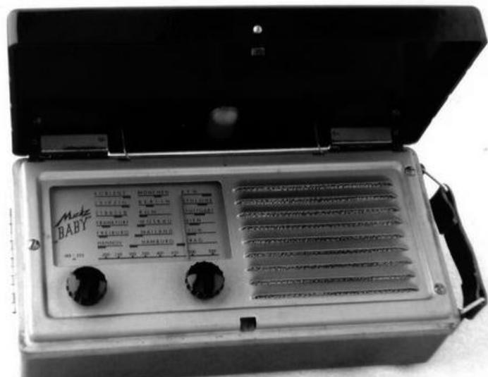
Bild 2: Metz Baby, ein handlicher Batterie-Kleinstsuper von 1950/51 für Mittelwelle im Zigarrenkisten-Format von 22x11x7 cm.
