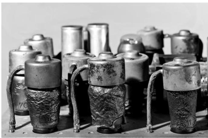
Bild 3: Schäden an den Beschichtungen verschiedener Elektronenröhren; (Fotos: H. Czech, DM).
