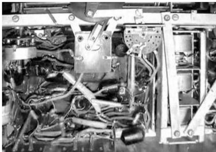
Bild 7: Ansicht der Verdrahtung. Ein Kondensator nicht original (links oben der Wima-Kondensator).
