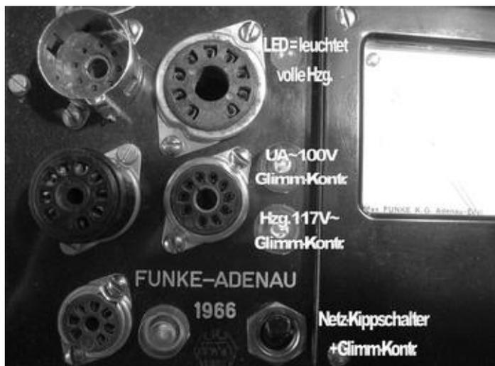
Bild 5: Glimm-Kontrolllampen im „W19“ eingebaut.
