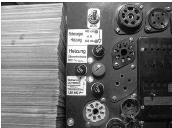
Bild 9. Detail der Frontplatte des „W20“, hier die Sicherungen links.
