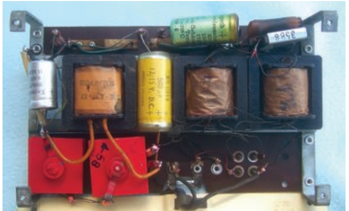
Bild 10. Innenansicht des Netzteilunterbaus: Rechts die beiden Netztransformatoren, links die Drossel für die Heizspannung. Der linke Selengleichrichter dient als Spannungsbegrenzer. Der wird meistens hochohmig und damit wirkungslos. Um die Röhrenheizungen nicht zu gefährden, empfiehlt es sich, zwei Siliziumdioden (1N4001 o. ä.) in Reihe parallel zu schalten (im Isolierschlauch unter dem linken Elko).
