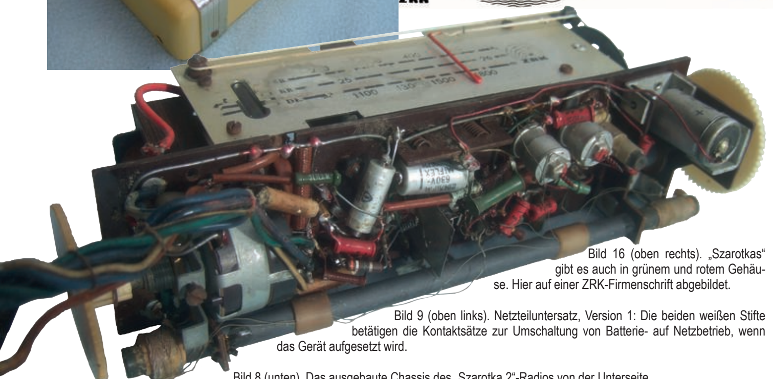
Bild 8 (unten). Das ausgebaute Chassis des „Szarotka 2“-Radios von der Unterseite.
