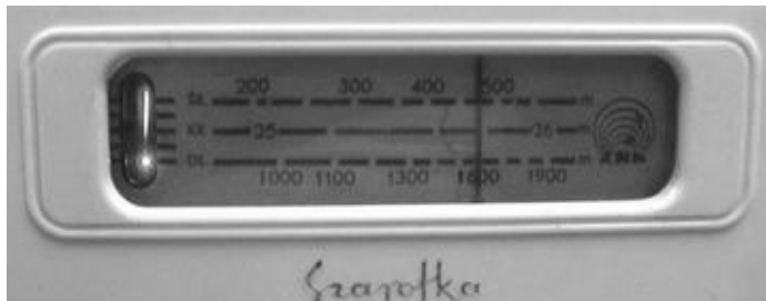
Bild 12. Links neben der Skala die Abstimmmanzeige mit dem „Magischen Ausrufungszeichen“ DM70.
