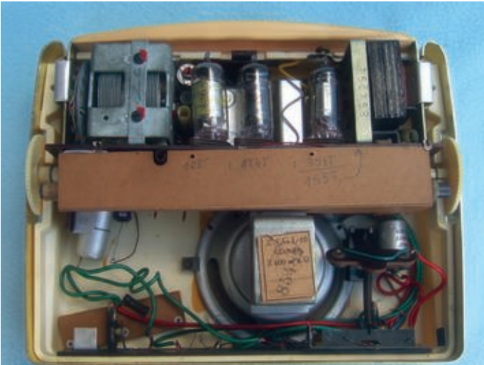
Bild 7. Innenansicht „Szarotka 2“: rechts unten der Halter für die zwei Monozellen (Heizung) und links daneben der Platz für die Anodenbatterie.
