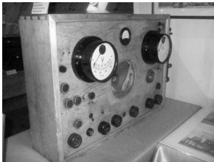
Technischer Zeitzeuge: Prüftafel aus einer Radiowerkstatt, Anfang der 1950er-Jahre.
