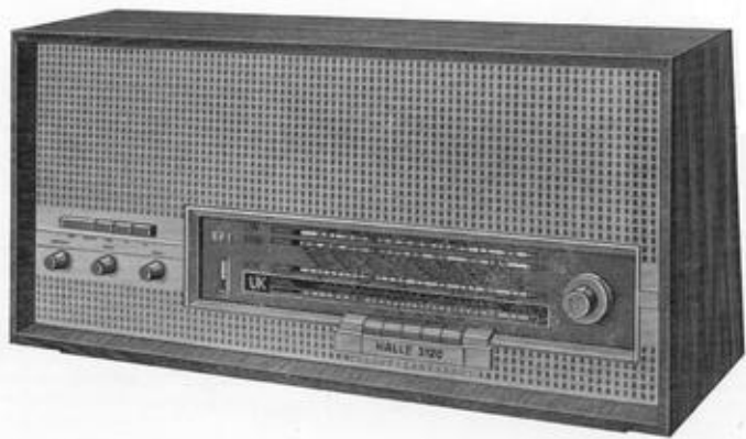
„Halle 5120“ (VEB Stern-Radio Sonneberg 1963-1966) Daten: Superhet 6 Kreise AM / 10 Kreise FM, Röhren: ECC85, ECH81, EBF89, EABC80, EM84, EL84, EZ80, Ausgangsleistung 2 W, Neupreis: 465 Mark, Sammlerpreise: ab 0 € bis 60 €.
