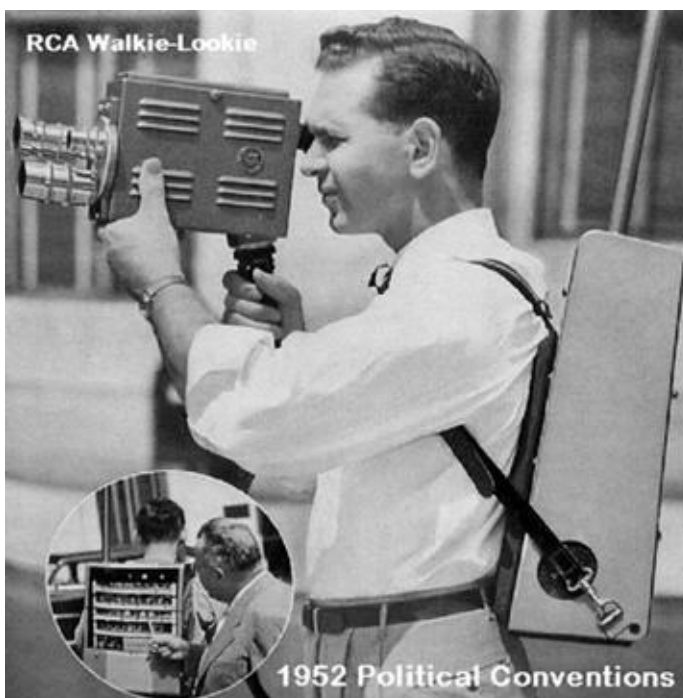
Bild 1: RCA „Walkie-Lookie“: Der Kameramann mit seinem Back-Pack vor dem großen Einsatz bei der 1952er Political Convention. Im Bild zu sehen auch der modulare Aufbau, an dem vor dem Einsatz „noch alle Schrauben nachzuziehen“ sind [5] [AM-FM-Television Broadcast News Vol. No 71, Sept.- Oct. 1952].
