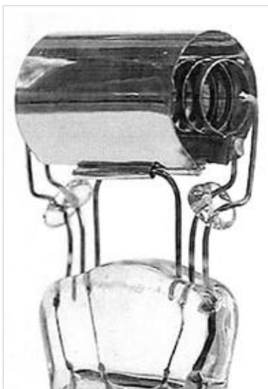
Bild 14: Entwicklungsgang der Telefunken-Triode EVE173, April 1914 bis Mai 1917. Oben längs: Versuchsröhre von W. SCHLOEMILCH mit zylindrisch-koaxialem System, 1914 [8].
