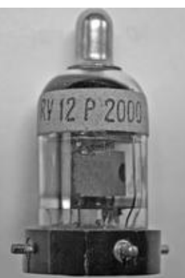
Geschickte Mitarbeiter mussten kompliziertere Wehrmachtsröhren wie die P700 und P2000 herstellen.
