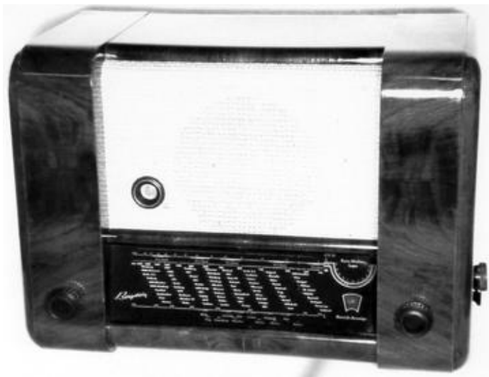
Bild 10: Bergstein „W 72“ von 1950/51, ein Siebenkreis-Fünfröhren-Superhet für K-M-L-Empfang, wahlweise mit oder ohne UKW-Pendler-Einsatz. Der Staßfurter „Imperial 50 WK“ von 1939/40 war hier das Vorbild.
