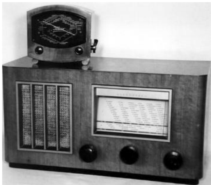
Bild 9: Telefunken-Dreiröhren-Zweikreiser „T 623 W“ von 1936/37 mit dem „Illux Telemann 3“ von 1949, der den 13 Jahre älteren Geradeausempfänger zum moderneren Superhet für K-M-L-Empfang macht.
