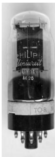
Zum Üben und Erlernen der Handarbeiten stellten Mitarbeiter der Röhrenfabrik zuerst die Gleichrichterröhren UY11 und UY1N her.
