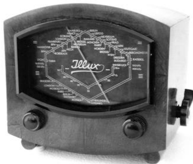
Bild 1: „Illux Telemann 3“ von 1949. Radio-Fernbedienung sowie alternativ Superhet-Vorsatz für K-M-L-Empfang mit beleuchteter Skala im kleinen Edelholzgehäuse von ca. 19 x 16 x 14 cm 3 .
