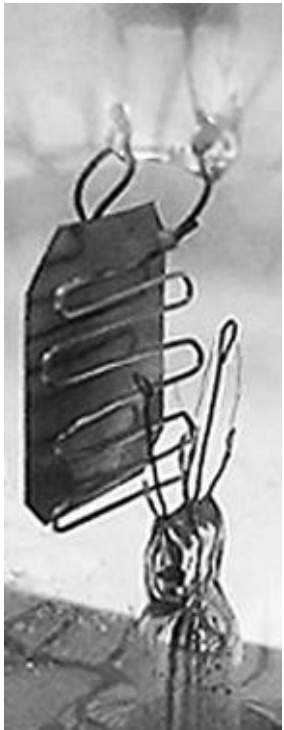
Bild 2 (links): Systemaufbau einer frühen Audion-Triode von DE FOREST [3].
