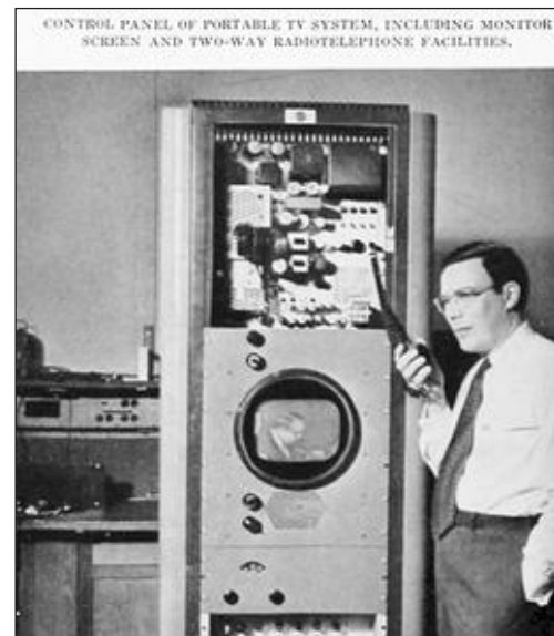
Bild 11: RCA „Walkie-Lookie“, die abgesetzte Empfangsgegenstelle mit Intercom, Kontrollmonitor und Synchronongenerator und Sender [4].
