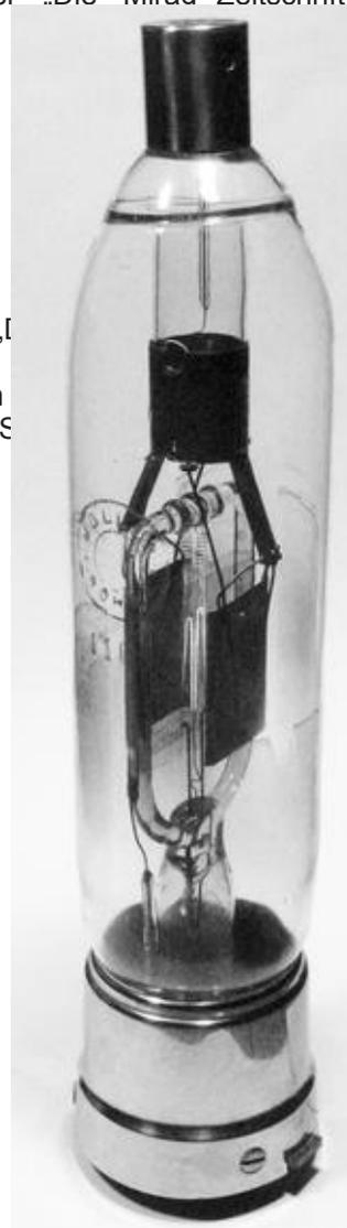
Bild 10. Senderöhre MSII von C.H.F. Müller. Bild: W. Eckardt
