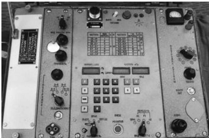
„Funkgerät R-394KM“, Blick auf die Frontplatte; in der Mitte oben Buchse für Stromversorgung, Aus/Ein-Schalter, Sicherung, Anschluss für Lampe, darunter Antennen- Abstimmtable für Sender, darunter Digitalanzeige für Eingabe von Spruchspeicherung/ Geschwindigkeit, daneben Frequenz für Empfänger und Sender, rechts im Sender oben Instrument für Spannungskontrolle und Senderabstimmung, darunter Schalter/Drehknopf für Antennenabstimmung.
