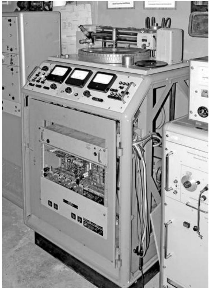
Schallplattenschneidemaschine der Fima Lyrek/Orthophon mit getrennten Schneidverstärkern mit Röhrentechnik von ca. 1958
