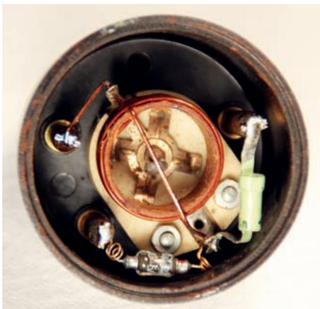
Bild 6: Blick in den „KW-Detektor-Empfänger“ mit Spule sowie Keramik- Trimmer im Zentrum und seitlich montierter Germanium-Diode.
