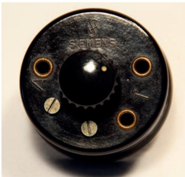
Bild 5: Siemens „Kurzwellen-Detektor-Empfänger“ mit zentralem Drehknopf, der den Keramik-Scheibentrimmer zwecks Senderabstimmung bewegt.
