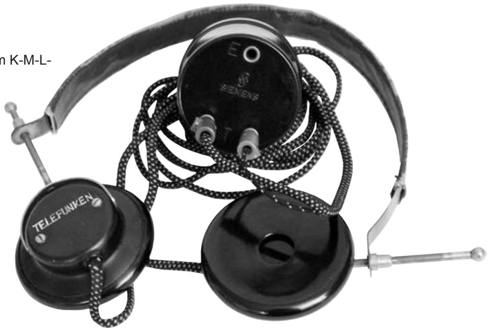
Bild 1: Siemens „Berlin-Stecker“ von 1946 mit einem Telefunken-Doppelkopfhörer einfachster Ausführung aus ersten Kriegsjahren.
