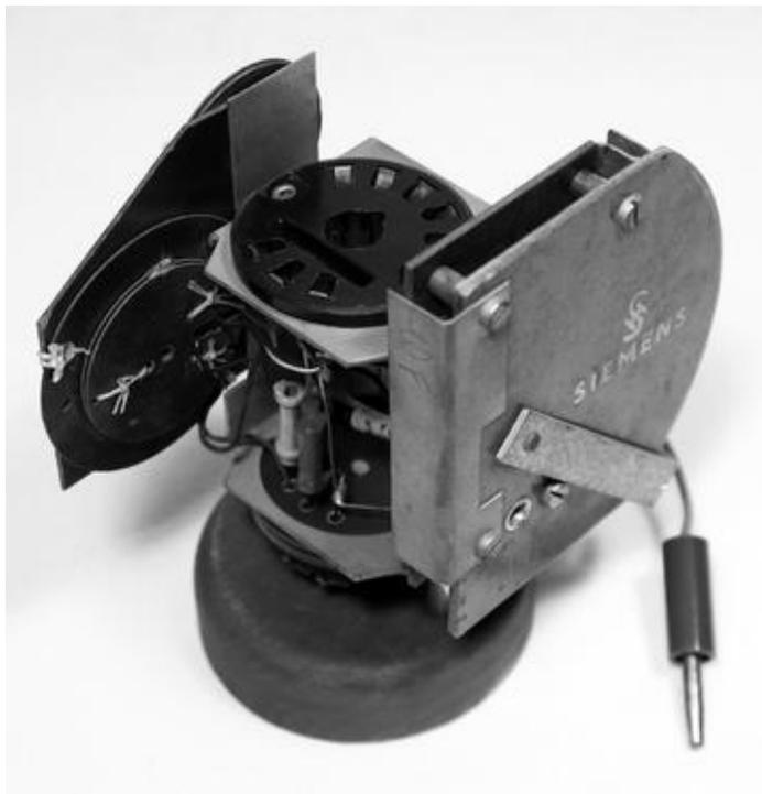
Bild 8: Siemens „Kurzwellen-Vorsatzgerät“, fixiert auf einer Holzbronde. Geeignet für den DKE und ähnliche Empfänger mit Röhre VCL11.
