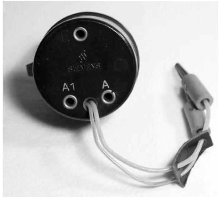
Bild 4: Siemens „Sperrkreis Rfz 46“ mit Buchsen für Antenne und Erde sowie Leitungen mit Steckern zum Anschluss an den Empfänger.
