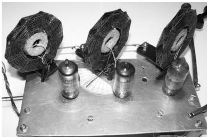
Versuchsaufbau mit Wabenspulen. Die Eigenschwingung setzt bei 48° aus.
