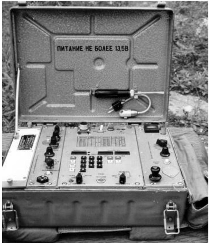
„Funkgerät R-394KM“, Gerät geöffnet, im Deckel kleine Lampe und Schraubendreher, darunter Gehäuse für Funkstation, ganz links Fach für Kopfhörer, Anschlusskabel für Stromversorgung und Kleinteile, dann Empfänger, Mitte Frequenzaufbereitung, Tastenfeld, Speicher/Codiereinrichtung, rechts Sender mit kleiner Morsetaste, außen rechts Fach für Antenne und Gegengewicht.
