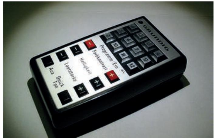
Ultraschall-Fernbedienung Telepilot 12 von Grundig.
