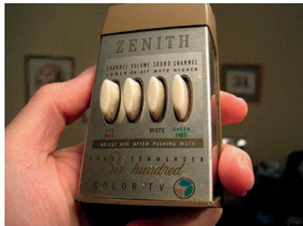
Die Fernbedienung „Space Control“ von Zenith funktionierte ohne Batterie und erzeugte Ultraschalltöne zur Steuerung des Fernsehers. (Bild: Jim Rees / Wikipedia)
